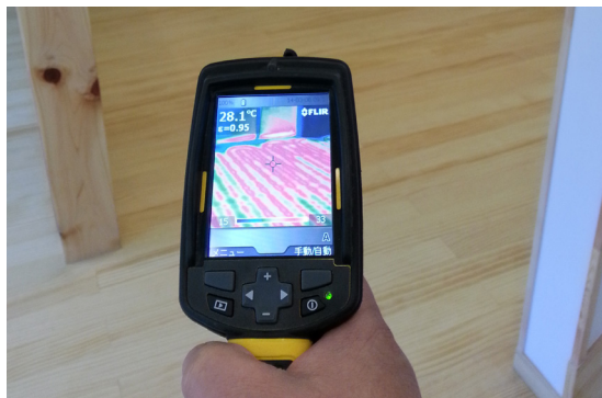
同社では床暖房の施工確認にもサーモグラフィ画像を使っています。温水を流せば温度差が生じるので、温めきる必要はなく、検査も短時間で済みます。
