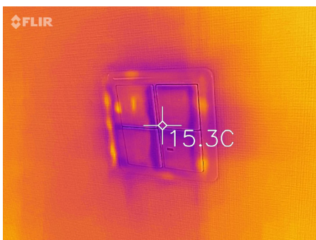
【画像1】気密不足でコンセントボックスなどから冷たい空気が入ってくるのがわかります。
